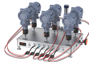
使用 125 批量检测压力变送器
