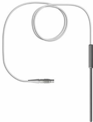
图 19 直杆智能标准温度计示意图
