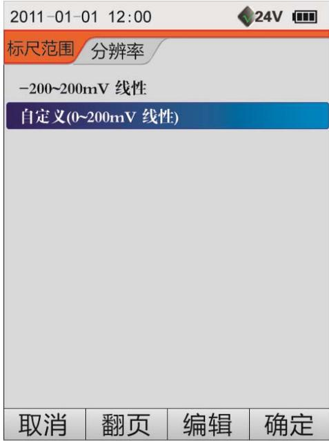
图 9.8 毫伏电压测量的设置
