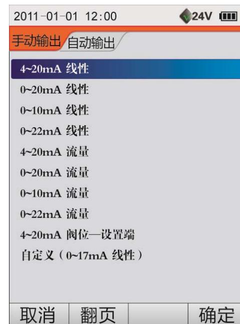
图 9.13 电流输出的设置
