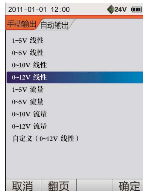
图 9.17 电压输出的设置
