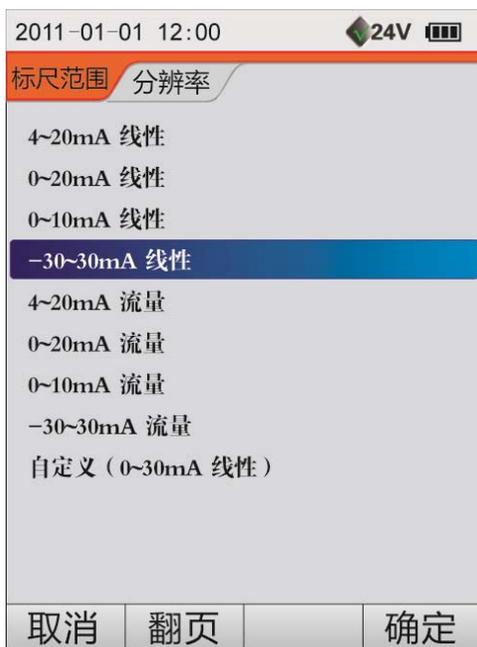
图 9.6 电流测量的设置
